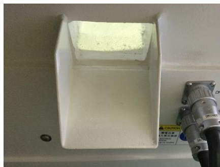
装置背面ドレン
