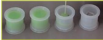
Technovit 4071 は、アクリルをベースにした速硬化性の樹脂です。粉末、リキッドの2成分で硬化させます。
